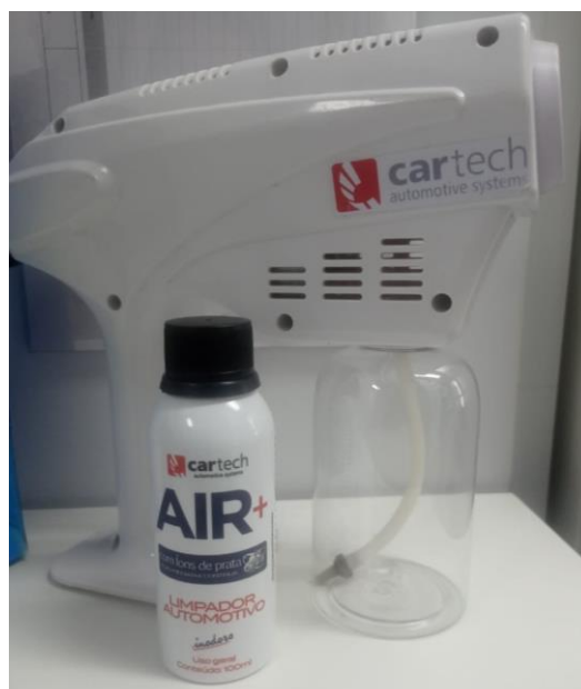
Figura 1. Dispositivo para nebulização Nano spray gun Cartech e limpador automotivo Air + contendo íons Ag+ (Cartech)
